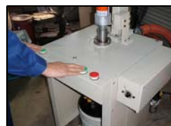
起動ボタンON(穴開け)
